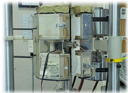
Komora grzewcza do zainstalowana na maszynie wytrzymałościowej (max. 1000°C)
